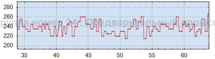
**Дизель - Список данных, группа номер 23 : Угол опережения основного количества впрыскиваемого топлива (21:04:18)**
