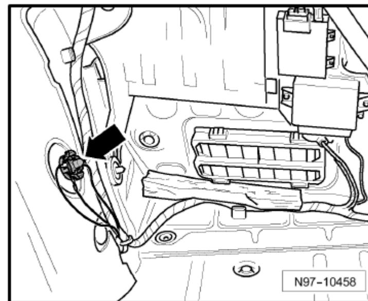
675 Точка соединения с массой 2 в багажном отсеке справа -стрелка-
