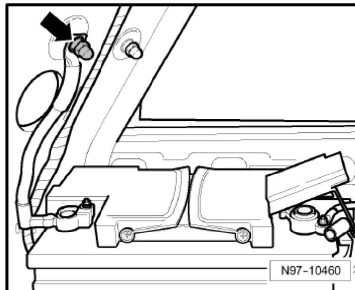
50 Точка соединения с массой в багажном отсеке слева -стрелка-
