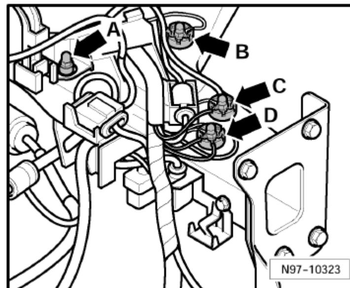
Точка соединения с массой на головке блока цилиндров -стрелка-
