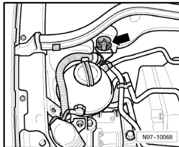
646 Точка соединения с массой 2 на перегородке моторного отсека -стрелка-
