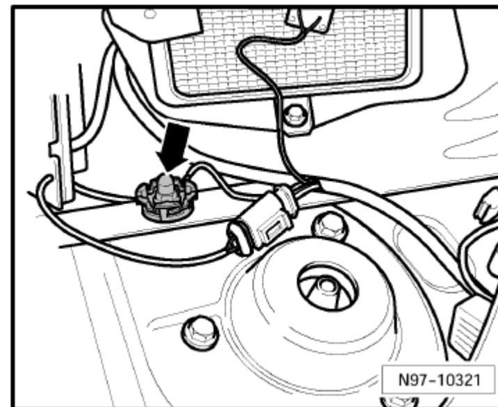
645 Точка соединения с массой 1 на перегородке моторного отсека -стрелка А-
