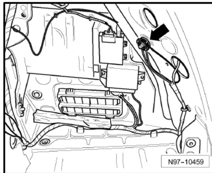
676 Точка соединения с массой 2 в багажном отсеке слева -стрелка-
